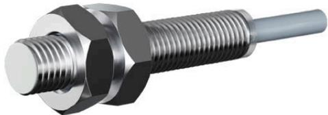
Индуктивный датчик KJ208-D02PB-D345-LY, нержавеющая сталь, заподлицо, диаметр M8, расстояние срабатывания 2 мм, PNP-НЗ, 3х проводное подключение, кабель 2 метра
