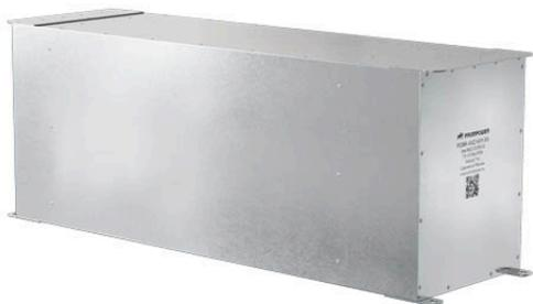
Тормозной резистор PROMPOWER PDBR-18K5-30R-100-T2, мощность 18,5 кВт, 30 Ом, ПВ 100% (120 с), IP 54, способ подключения: клеммная колодка, корпус из оцинкованной стали, габарит Д50 (Ширина 240 мм; Высота 350 мм; Длина 835 мм) масса 30 кг. Датчик температуры РТС
