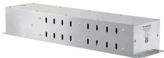
Тормозной резистор PROMPOWER PDBR-18K5-30R-5, мощность 18,5 кВт, 30 Ом, ПВ 5% (120 с), IP 54, способ подключения: клеммная колодка, корпус из оцинкованной стали, габарит M2 (Ширина 80 мм; Высота 65 мм; Длина 460 мм) масса 4 кг.
