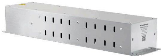
Тормозной резистор PROMPOWER PDBR-1K5-170R-40, мощность 1,5 кВт, 170 Ом, ПВ 40% (120 с), IP 54, способ подключения: клеммная колодка, корпус из оцинкованной стали, габарит M2 (Ширина 80 мм; Высота 65 мм; Длина 460 мм) масса 4 кг.
