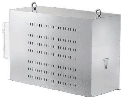
Тормозной резистор PROMPOWER PDBR-75K-10R-100, мощность 75 кВт, 10 Ом, ПВ 100% (120 с), IP 54, способ подключения: клеммная колодка, корпус из оцинкованной стали, габарит Д160 (Ширина 420 мм; Высота 700 мм; Длина 975 мм) масса 130 кг.
