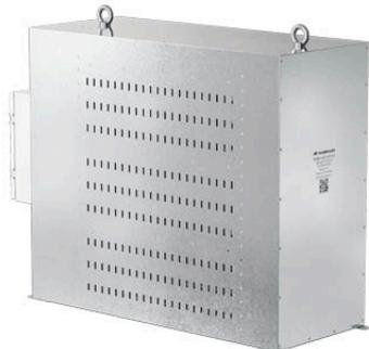
Тормозной резистор PROMPOWER PDBR-90K-8R-100, мощность 90 кВт, 8 Ом, ПВ 100% (120 с), IP 54, способ подключения: клеммная колодка, корпус из оцинкованной стали, габарит Д200 (Ширина 420 мм; Высота 850 мм; Длина 975 мм) масса 170 кг.
