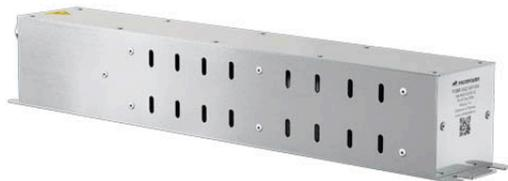
Тормозной резистор PROMPOWER PDBR-K75-170R-5, мощность 0,75 кВт, 170 Ом, ПВ 5% (120 с), IP 54, способ подключения: клеммная колодка, корпус из оцинкованной стали, габарит М1 (Ширина 70 мм; Высота 45 мм; Длина 460 мм), масса 2 кг.
